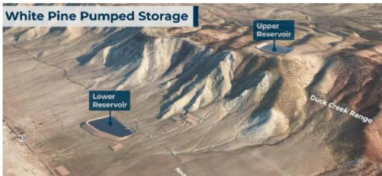
По данным rPlus Hydro, выбранный под строительство участок отвечает всем требованиям, предъявляемым к ГАЭС, что является достаточно редким явлением. Мощность ГАЭС White Pine в турбинном режиме составит 1 ГВт, энергоёмкость – 8 ГВт\*ч. Ожидается, что станция сможет обеспечить примерно 1/8 пиковой нагрузки энергосистемы штата в жаркий летний день. Совокупный объем инвестиций в ее строительство составит \$ 2,5 млрд.
