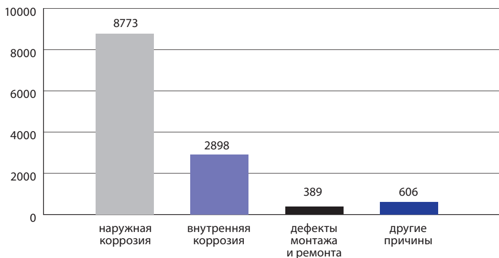
Рис. 2.9 Причины повреждений трубопроводов тепловых сетей
