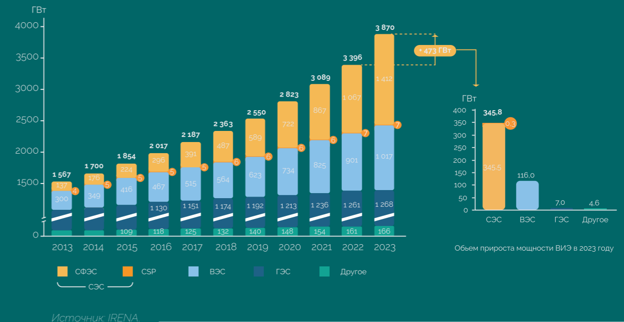
Рис. 1. Совокупная установленная мощность ВИЭ-генерации в мире и объем прироста энерго мощностей ВИЭ в 2023 году, ГВт
